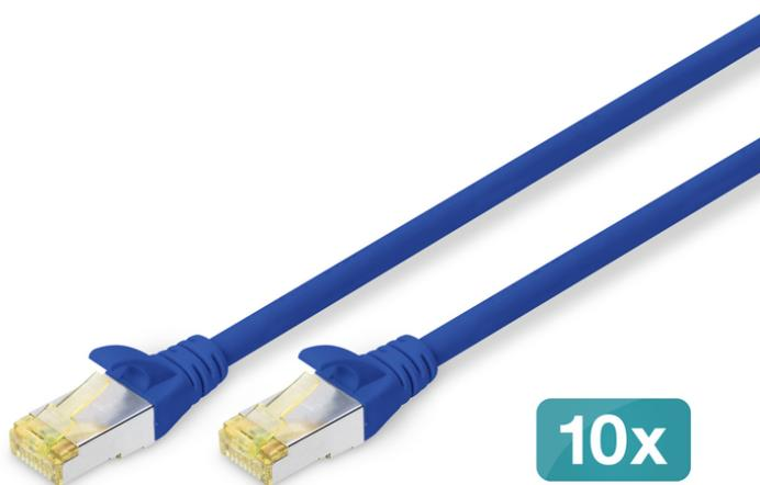
**Cabo de ligação CAT 6A S-FTP, cobre, LSZH AWG 26/7, comprimento 3 m, 10 unidades, cor azul**
