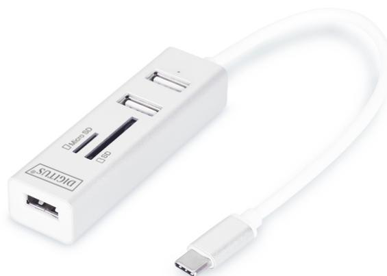
**HUB USB 2.0 Type-C con lettore di schede 3x USB 2.0. 1x SD, 1x porta MicroSD, alluminio**
