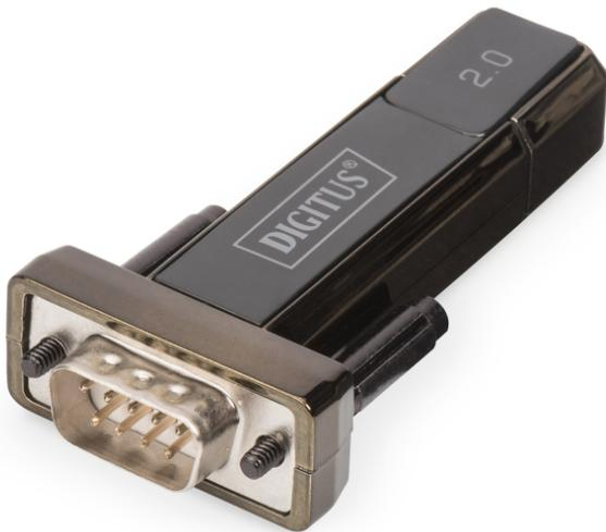
**Conversor de USB 2.0 a serie, DSUB 9M incl. cable USB A 80cm, chipset FTDI**
