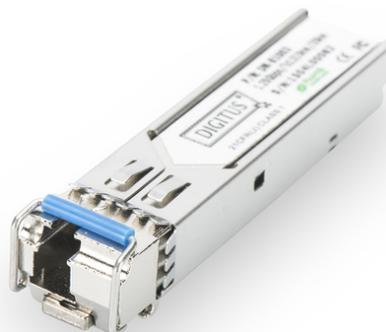
**1.25 Gbps SFP Module, Singlemode, BiDi LC Simplex, Tx1310nm/Rx1550nm, bis zu 20km**
