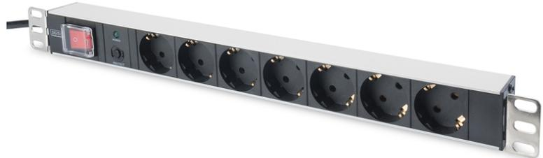
**1HE Aluminium PDU, Rack Mount, 7x Schutzkontakt 16A, 4000W, 250VAC 50/60Hz, Überlastschutz**
