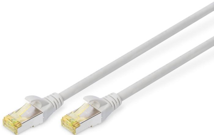
**CAT 6A S-FTP Patchkabel, Cu, LSZH AWG 26/7, longueur 1,5 m, couleur grise**
