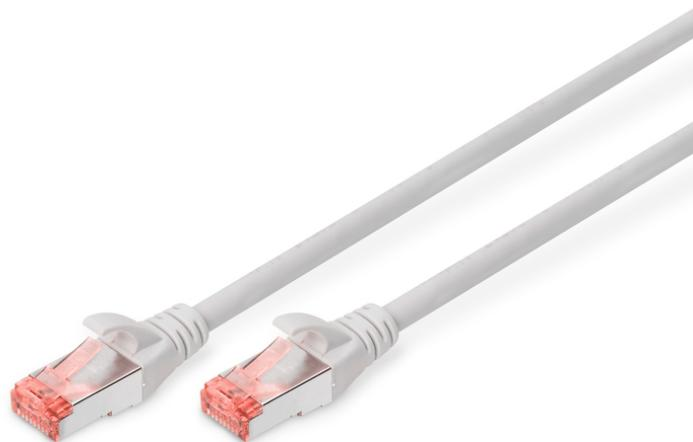
**CAT 6 S-FTP Patchkabel, Cu, LSZH AWG 27/7, Länge 2 m, Farbe Grau**
