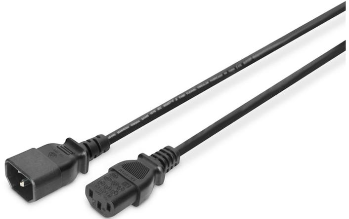
**Netzverlängerungskabel, C14 - C13 St/Bu, 1.2m, H05VV-F3G 0.75qmm, sw**
