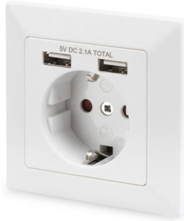
**Toma de corriente con contacto de puesta a tierra, 2 USB, potencia total USB 5 V 2,1 A, entrada: 250 V CA 50 Hz, RAL 9003**
