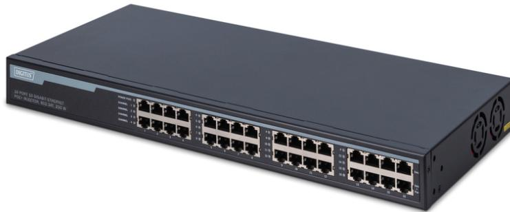
**10G Ethernet PoE+ Injector Hub, 802.3at 16-port, Power Pins:3/6(+), 1/2(-), 250W**
