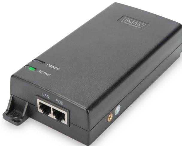
**Injecteur PoE Ultra, 802.3at Pins de puissance:4/5(+),7/8(-) et 3/6(+), 1/2(-), 60W**
