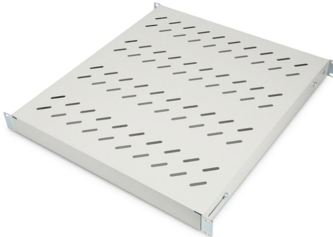
**Tablette 1U à montage fixe pour armoires de 800 mm de profondeur 44 x 482 x 500 mm, réglage en profondeur de 500 à 700 mm, gris**
