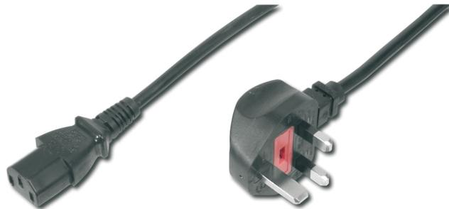
**Netzanschlusskabel, UK Stecker, 90° gewinkelt -C13 St/Bu, 1,8m, H05VV-F3G 0,75qmm, Sicherung 5A, sw**
