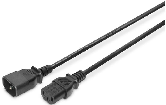
**Netzverlängerungskabel, C14 - C13 St/Bu, 5.0m, H05VV-F3G 1.0qmm, sw**
