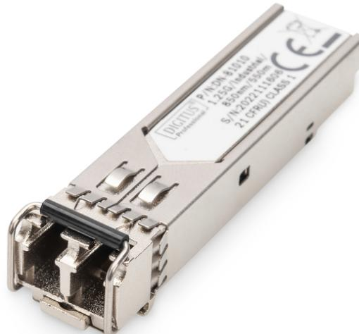
**Modulo SFP da 1,25 Gbps, multimodale, versione industriale.****Connettore duplex LC, 850nm, fino a 550m**
