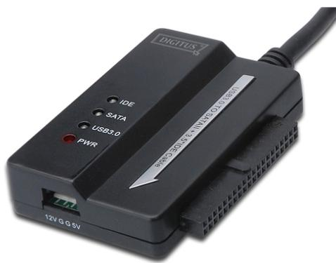
**USB3.0 zu SATAII + 3.5" IDE Adapter Kabel, Netzteil (12V/2A) im Lieferumfang enthalten**
