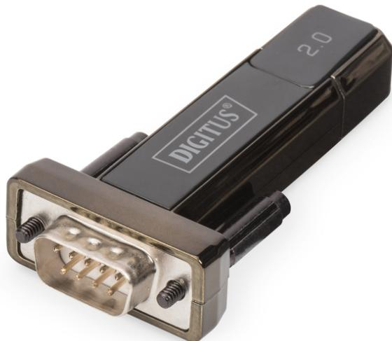
**USB 2.0 auf serieller Konverter, DSUB 9M inkl. USB A Kabel 80cm, FTDI Chipsatz**
