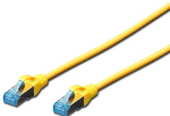
**Cavo patch SF-UTP CAT 5e, rame, PVC AWG 26/7, lunghezza 5 m, colore giallo**
