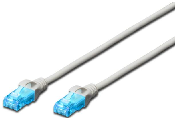
**Cable de conexión U-UTP CAT 5e, cobre, PVC AWG 26/7, longitud 20 m, color gris**
