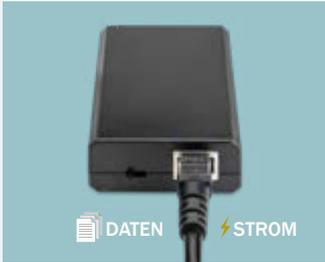
**1.** Über das Netzkabel werden sowohl Strom und Daten zum PoE-Splitter transportiert.
